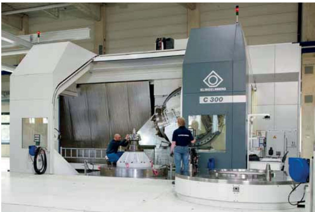
Bild 2: Auf der Verzahnmaschine C 300 erfolgt das Weich- und Hartverzahn von Großkegelrädern
