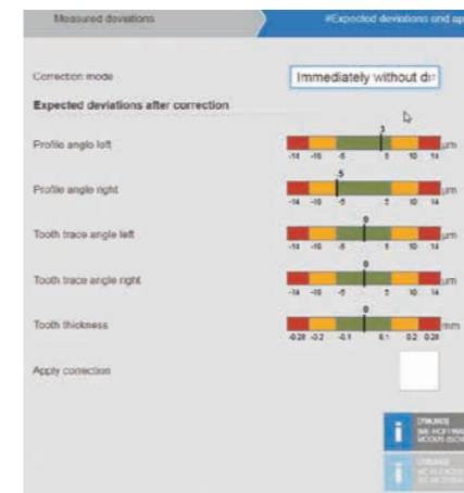
Abb. 2: Prozesssteuerung mit integriertem Closed Loop System
